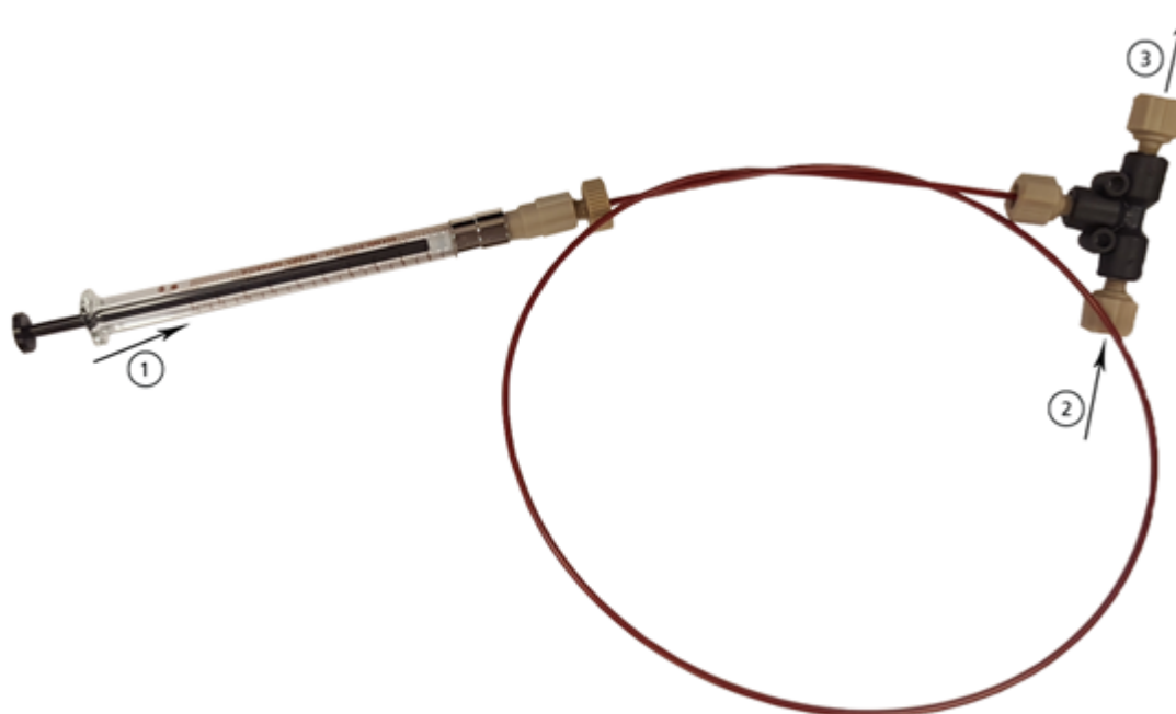
Illustration 4-1 : Configuration du raccord en T pour perfusion
