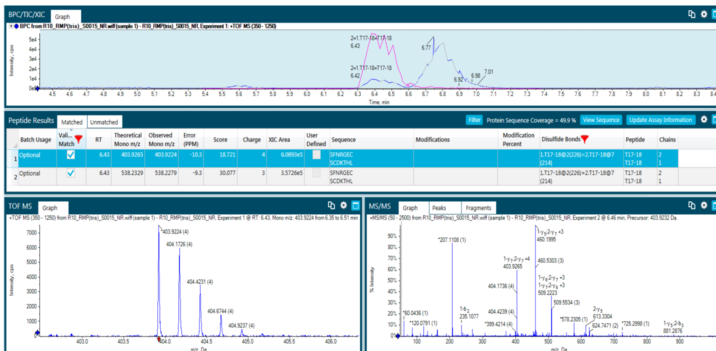
图4. 轻链和重链链间C214-C226二硫键的鉴定结果，第一栏展示的是对应肽段的一级提取离子色谱图，第二栏展示的是C214-C226二硫键通过软件确认的2个电荷态以及二级的得分，第三栏展示的是对应二硫键肽段的一级和二级质谱图。
