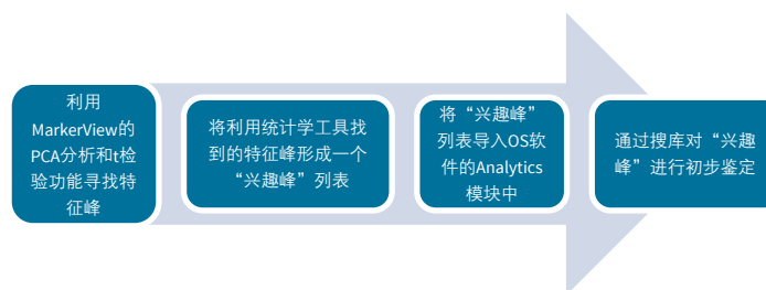
图4. 基于统计学的工作流程。 在搜库之前，使用MarkerView软件挖掘最有显著性差异的数据。在这个工作流程中，目的只是鉴定那些可以区分不同类型样本的特征峰。
