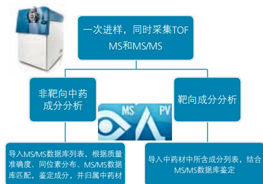
图1. 应用TripleTOF®系列质谱，结合MS/MS 数据库，鉴定中药成分工作流程。
