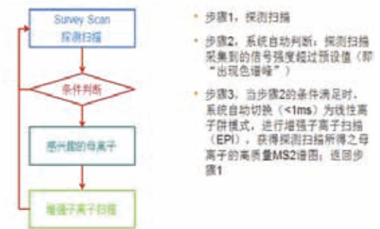
图1b. Qtrap: MRM触发IDA工作原理。
