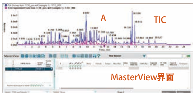
图2. 数据依赖采集高分辨的MS 和MS/MS 用于中药成分鉴定
